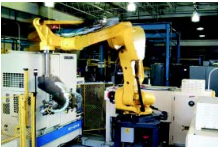
应用高科技制造单元加工蓄能器部件
