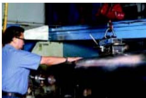
在大型车床上加工大缸径活塞式蓄能器
